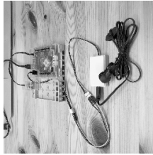
図8 Studuino に接続した脈拍センサとLED
